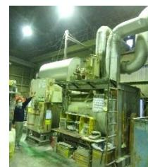
従来の高温熱処理乾燥装置
